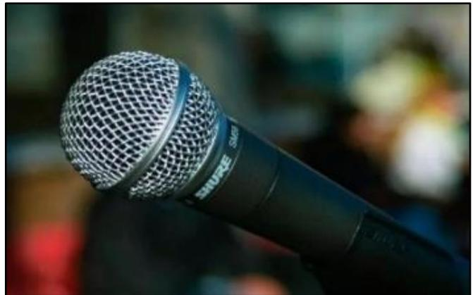
Le son d'un micro dynamique est souvent jugé moins fidèle à la source sonore et souvent un peu trop rond (une table de mixage simple ne permettra pas « d'arranger » véritablement le son à sa convenance, celle-ci étant généralement équipée simplement d'un niveau de volume pour chaque source sonore captée, de réglage des grave, médium, aigu, d'une réverbère, d'un volume général).
